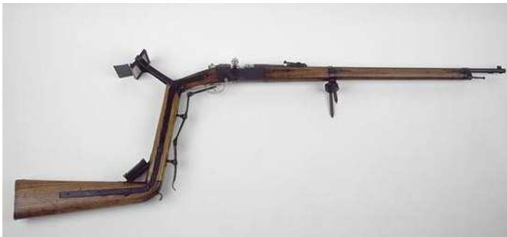
Fusil Lebel de tranchée. Métal, bois, verre. H. 56 ; L. 160 ; l. 15 cm. Paris, musée de l'Armée. Inv. 999.462. Prototype, calibre 8 mm, réalisé par la manufacture d'armes de Tulle.
